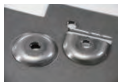
エンボス後、タップ Tapping after Emboss Forming
