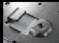
エンボス Emboss 切り起し Flanging タップ Tapping (M4)
