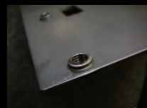
バーリング Burring タップ Tapping (M8)
