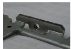
タップ後、上曲げ Upper bending After Tapping
