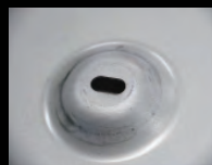
エンボス Emboss エンボス後の長穴抜き Around blanking after emboss working
