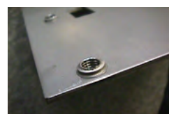
バーリング、タップ Burring and Tapping
